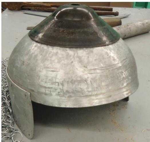
3. Сверлим отверстия  $\varnothing 2,5$  мм. Для крепления бармицы.
